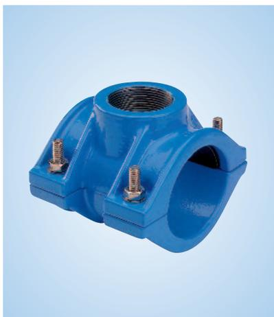
Il collare a manicotto semplice è formato da due semicilindri in ghisa sferoidale interamente rivestiti con polvere epossidica atossica (conforme al D.M. 174/04), uniti da quattro bulloni in acciaio zincato.
