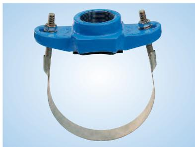
Il collare di presa universale è adatto per tubazioni in ghisa, cemento-amianto e acciaio. Il corpo è in ghisa sferoidale con guarnizione in gomma incorporata, i dadi e le rondelle in acciaio zincato e la staffa in acciaio inox. La verniciatura eseguita mediante procedimento elettrostatico con polvere epossidica atossica e tutti i componenti in gomma NBR atossica sono conformi al D.M. 174/04.
