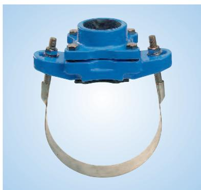
Il collare di presa in carico è costruito con gli stessi materiali impiegati per il collare presa universale, ma viene utilizzato per le derivazioni su condotte in pressione.
